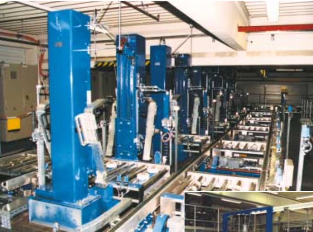
Installation einer kompletten Palettenförderanlage über mehrere Etagen für das Unternehmen Thyssen - Krupp
